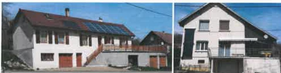
Exemples de panneaux solaires en toiture et de capteurs solaires tubulaires sur façade
